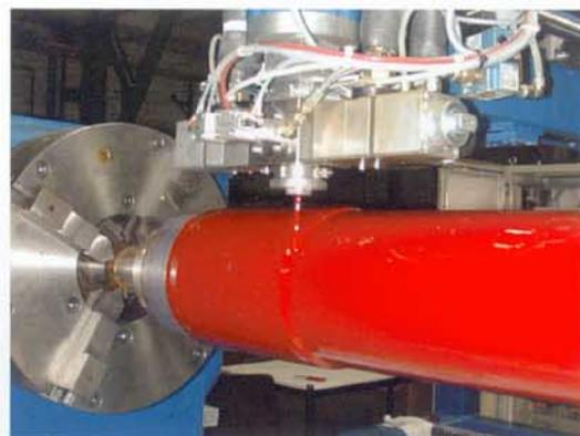
*Rotationsgießanlage zur Herstellung von Kunststoffwalzenbezügen*
