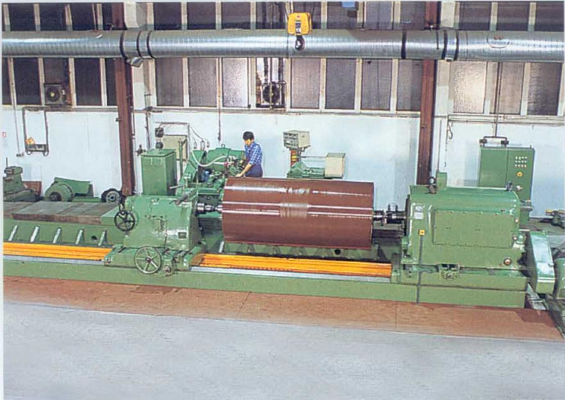
*Schwere Walzenschleifmaschine für Präzisionsschliffe*
