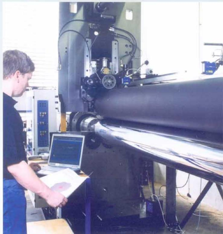
*KBA-Simulationsprüfstand zur Prüfung von Presseigenschaften*
