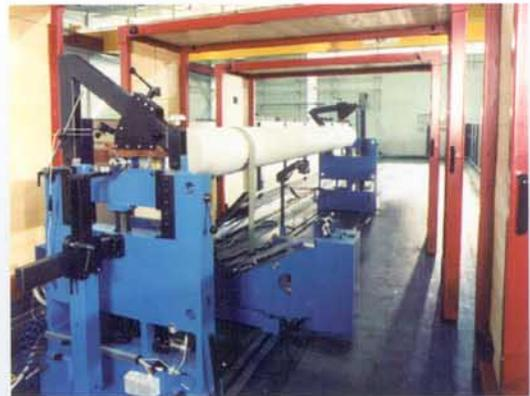
*Dynamisches Auswuchten von Walzen in einer Schenk-Anlage*
