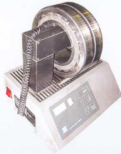
*Induktionswärmegerät zur Lagermontage*
