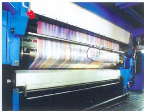
KBA Druckwerk mit MITEX Presseur
