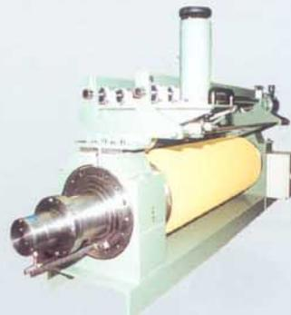
BFI/Sundwig - Planheitsmeßrolle mit MITEX Hochleistungsbeschichtung HIGH DYNAMIC
