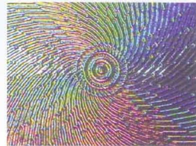
Hologramm-Folie geprägt mit MITEX Beschichtung HOLODUR
