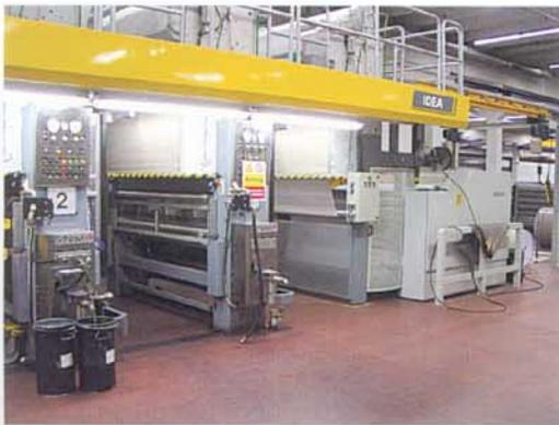
Schiavi - Verpackungsdruckanlage IDEA 1880 mm DB
