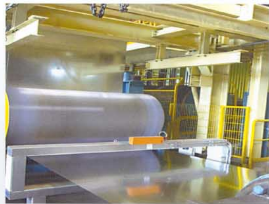
Salzgitter Flachstahl AG Treib-/S-Rolle mit MITEX Non-Slip-Beschichtung ULTRADUR
