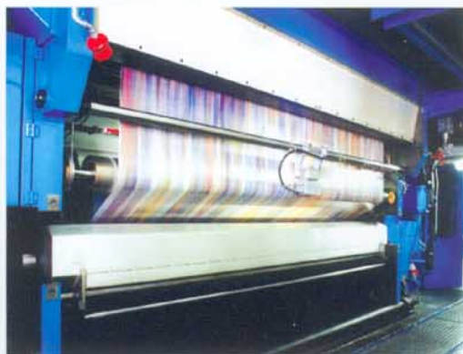
KBA Druckwerk mit MITEX Presseur Tiefdruckrotation 3650 mm DB bei 15m/s
