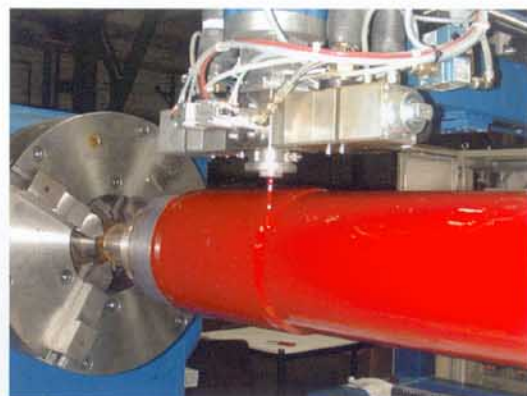
Rotationsgießanlage zur Herstellung von Kunststoffwalzenbezügen
