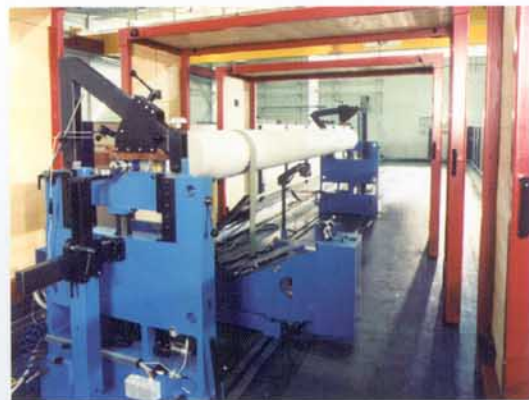
Dynamisches Auswuchten von Walzen in einer Schenk-Anlage
